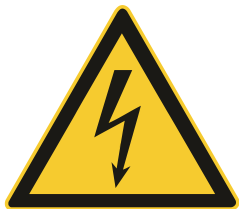
Bild – Kennzeichnung zur Warnung vor gefährlicher elektrischer Spannung
